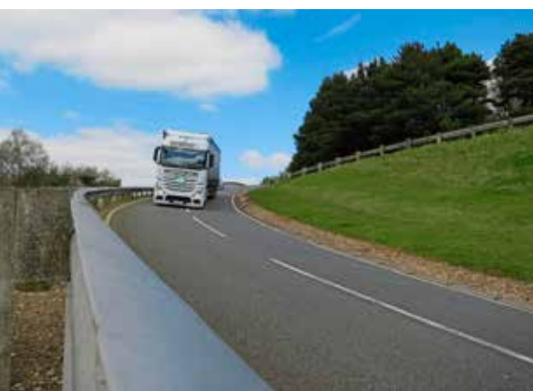
Selbst bei 21 Prozent Gefälle im vierten Gang reduziert HPD die Geschwindigkeit des Lkw.
